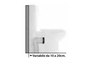
Cod. **VA078**Curva tecnica per scarico pavimento regolabile da 20 a 27 cm.
