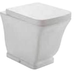
Cod. **RE01.BI**Vaso a terra scarico a parete. Trasformabile a pavimento tramite la curva tecnica VA079 fornita a richiesta. Installazione filo parete. Scarico 4,5 / 3 Lt. Completo di fissaggi.
