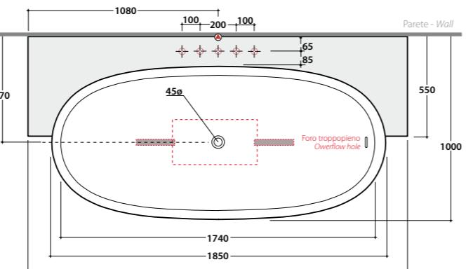
Vasca in Pietraluce. Installazione a parete mediante l'ausilio di una mensola. Completa di kit di fissaggio e sistema di scarico.
