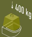
Test di resistenza meccanica. Ogni prodotto viene sottoposto ad un test di resistenza meccanica (es. 400 kg per i vasi e 150 kg per i lavabi).
