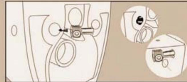
Установите деталь C в монтажное отверстие чаши;
