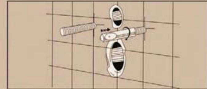
Установите деталь B на резьбовую шпильку инсталляции;
