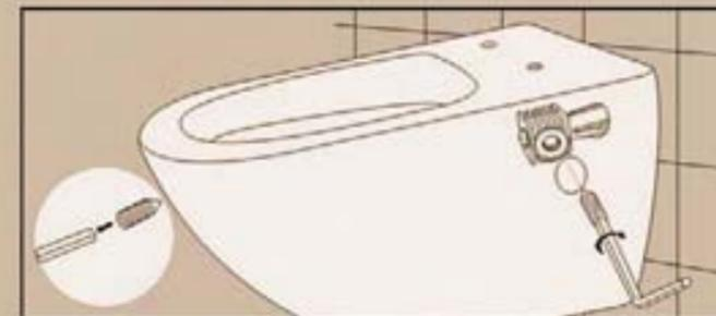
Закрепите конструкцию, используя соединение деталей C и D при помощи ключа A;
