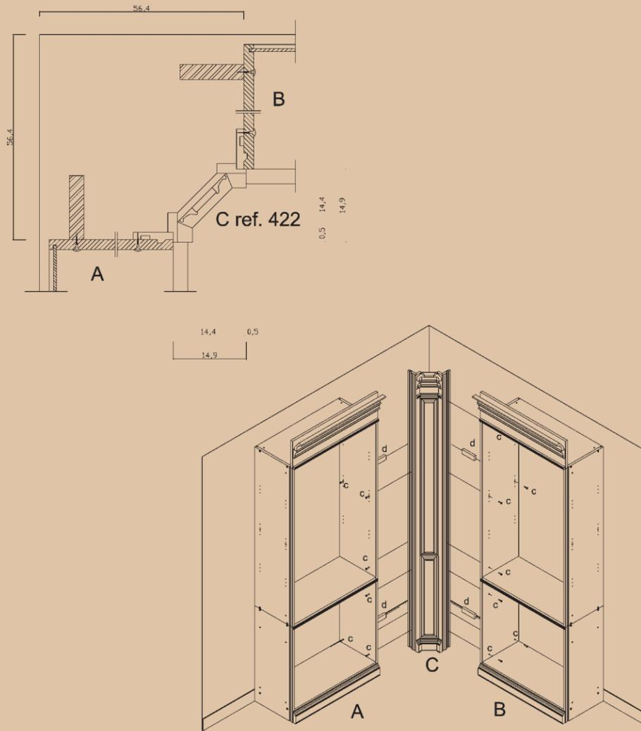
Montaje Módulo a Módulo en Rincón a 90°.
