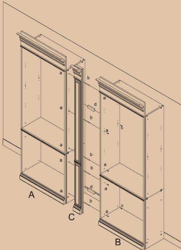
Montaje Módulo a Módulo
