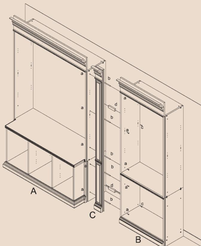
Montaje Módulo a Módulo TV. o Chimenea
