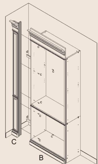
Montaje Módulo Terminal a Pared
