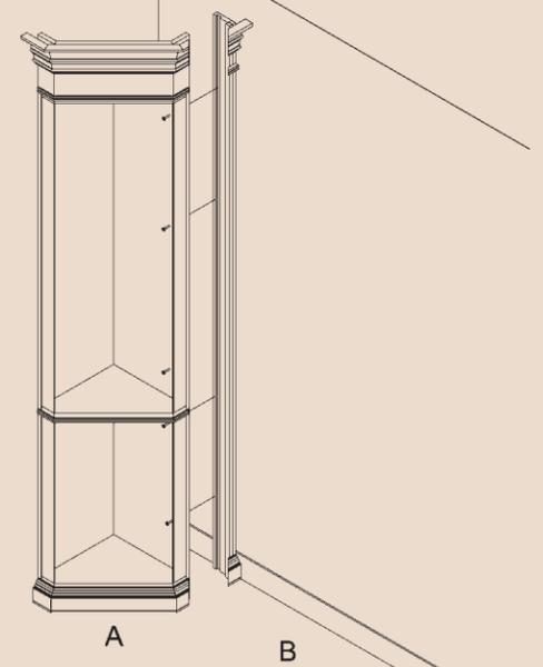
Montaje Módulo Terminal con Paneles
