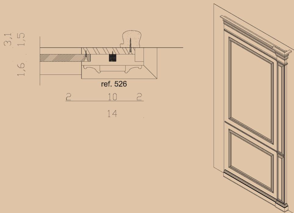
**Montaje Paneles con Pilastra Rincón a 90°.**
