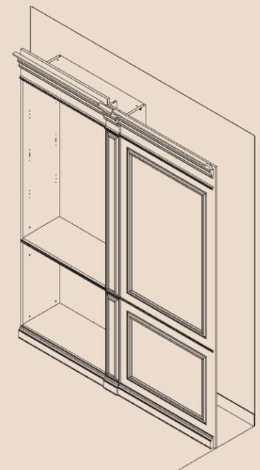
Montaje Módulo a Panel, con Costado Terminal.
