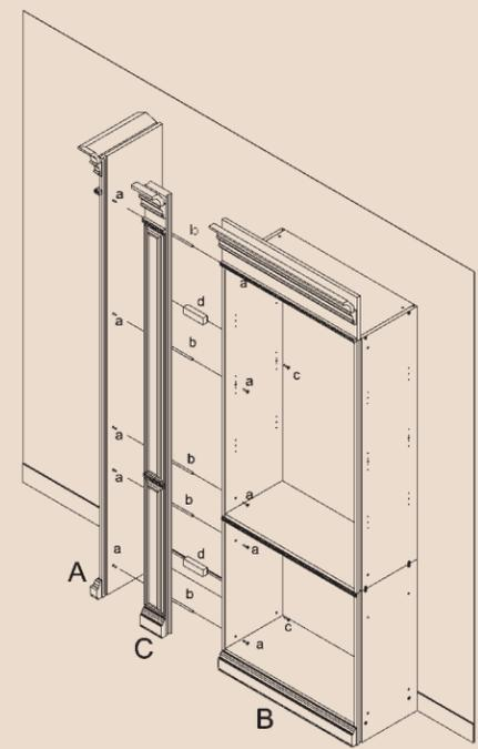
Montaje Módulo a Pared
