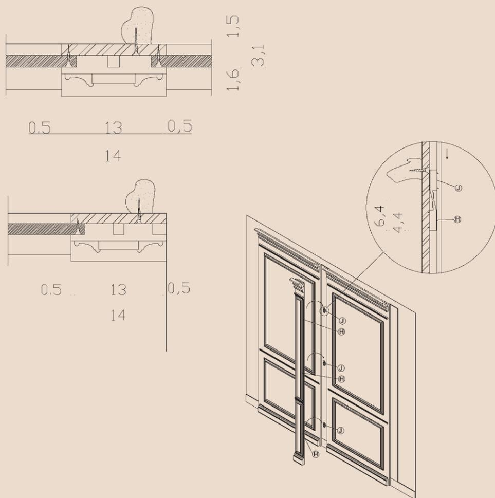
**Montaje Paneles con Pilastra Terminal.**
