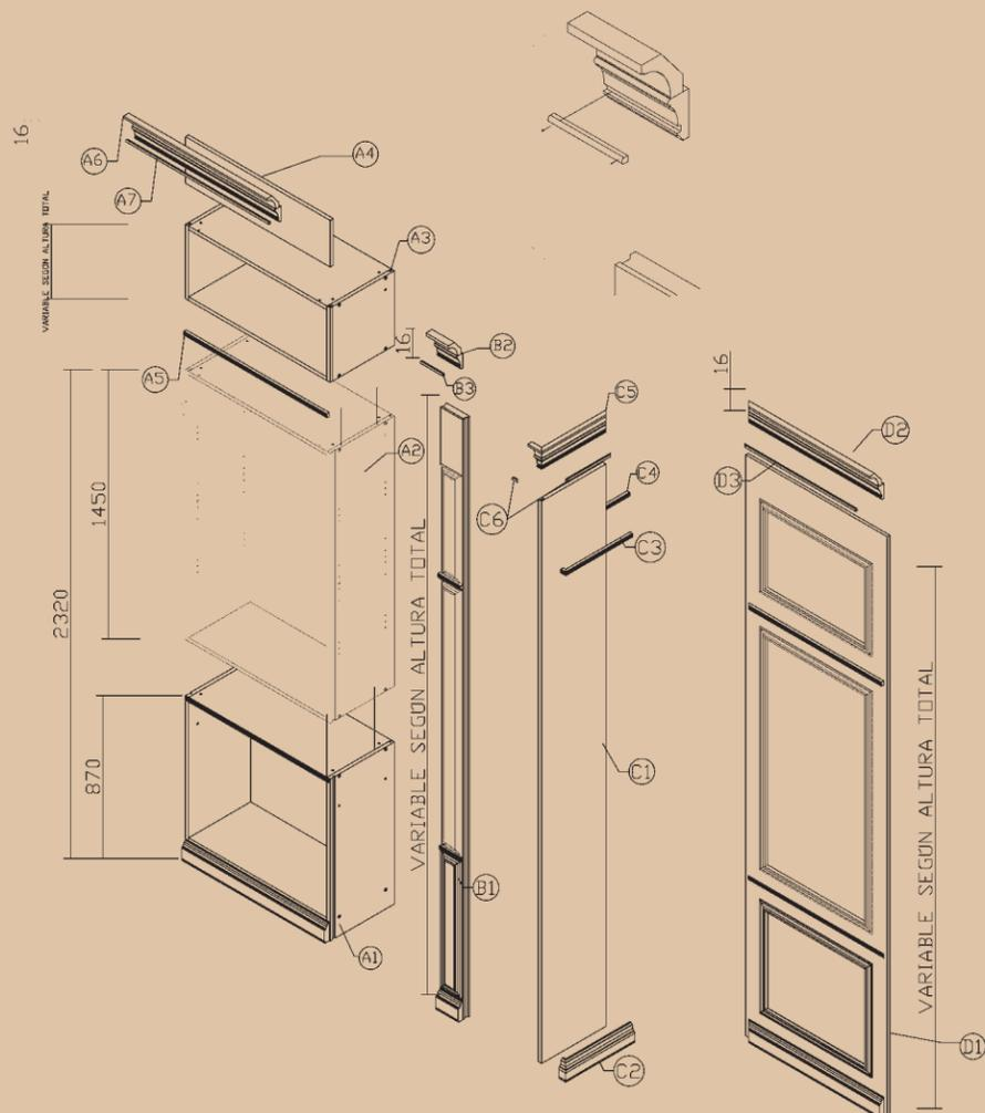
**Esquemas de Montaje de Módulos**
